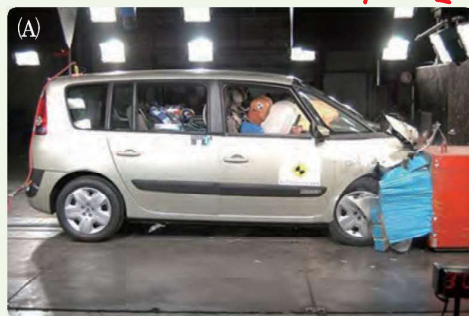
▲ (A) 牆壁施於汽車的巨大力量，使得汽車前端受損的程度非常嚴重。(B) 汽車撞擊牆壁時，其動量的變化情形。
