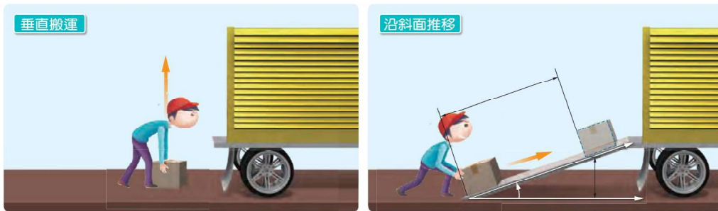
▲ 圖 8-14 自地面垂直上提木箱至貨車內，與沿斜面推動木箱至貨車內，此兩外力所作的功相同。若木箱均以相同速率等速運動，由於垂直上提的距離較短，花費時間較少，故功率較大，但也因此較為費力。
